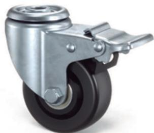
Garfo estampado em chapa de aço com acabamento zincado. Cabeçote giratório com 2 pistas de esferas. Freio total (roda e giro).
